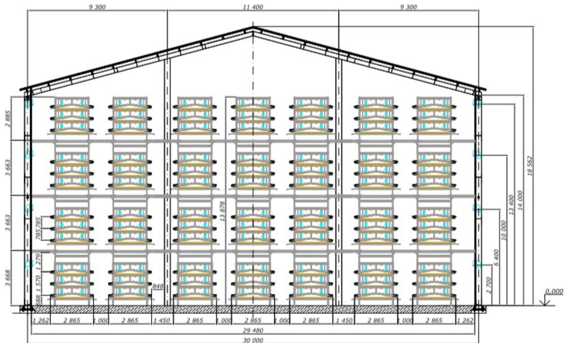
3.6. attēls. Dējējvistu turēšanas novietnes šķērsriezuma profils
