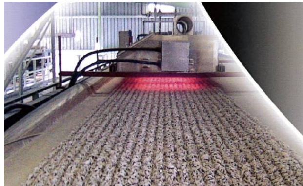
3.19. attēls. Infrasarkano staru žāvēšanas iekārta
